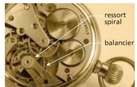
Fig. 4 : la montre n'est qu'un pendule élastique avec ressort spiral.
