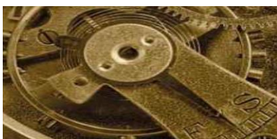
Dans les montres mécaniques, le ressort spiral tient lieu de balancier.
