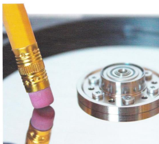
8 Plateau d'un disque dur en gros plan. Les plateaux sont polis afin de limiter l'échauffement provoqué par le frottement de l'air sur la surface. Il faut que cette surface soit parfaitement plane pour que les têtes de lecture, qui « volent » à une hauteur de 10 nanomètres au-dessus des plateaux, ne rencontrent aucun obstacle.
